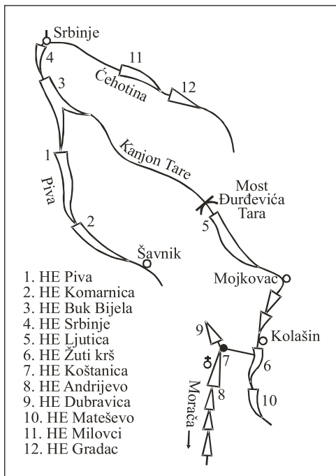
Sl. 1. Jedna varijanta korišćenja gornjeg sliva Drine sa prevođenjem dijela vode Tare u Moraču
