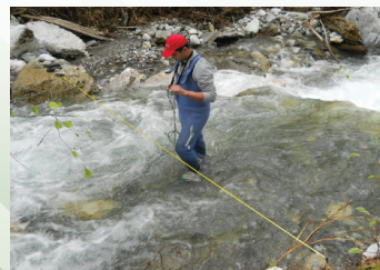
Mjerenja hidrometrijskim krilom na rijeci Bradavac
