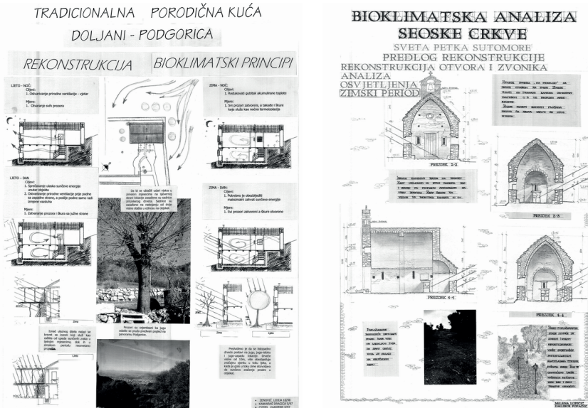
Slika 4: Idejna rješenja bioklimatske rekonstrukcije/rehabilitacije za jedan ruralni stambeni i jedan ruralni sakralni objekat iz oblasti crnogorskog krasi i primorja
