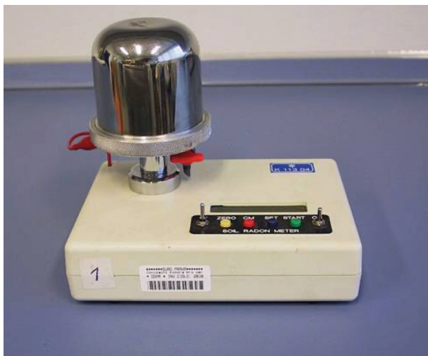
Slika 3. Elektrometar ERM-3, sa jonizacionom komorom na njemu
