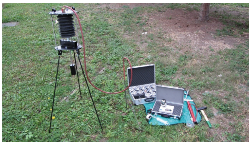
Slika 2. Uređaj RADON-JOK (lijevo na slici) za mjerenje permeabilnosti tla, i sistem RM-2 (desno na slici) za mjerenje koncentracije radona u tlu na lokaciji mjerenja
