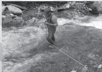
Mjerenja hidrometrijskim krilom na rijeci Bradavec
