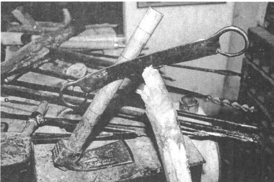
6. Тесла за кроење и "колски" нож за делкање на дрво 6. Тесла за кроење и "колски" нож за дељање дрвеша
