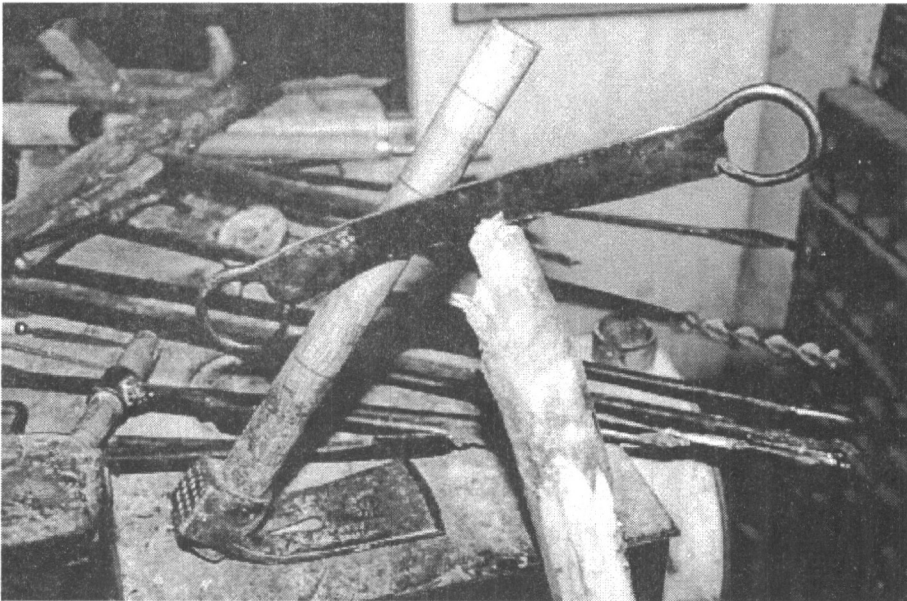
6. Тесла за кроење и "колски" нож за делкање на дрво 6. Тесла за кроење и "колски" нож за дељање дрвећа
