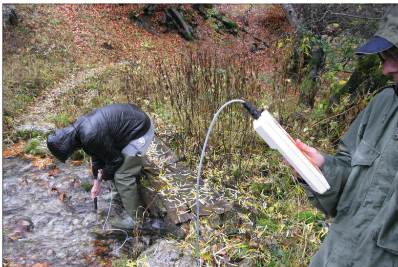
Slika 1. Mjerenje protoka pomoću Flow-Tracera na Simovom potoku
