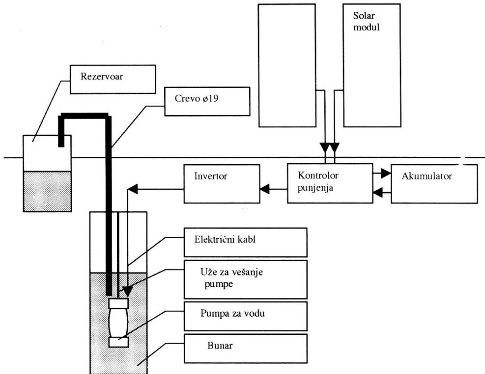
Slika 1: Blok shema solarnog sistema za navodnjavanje
