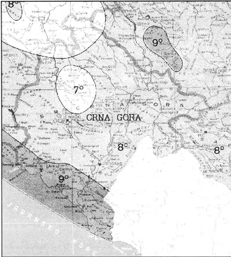
Slika 1. Očekivani maksimalni intenziteti u periodu od 500 godina (1987. god.) kao osnovna seizmološka podloga za projektovanje objekata II i III kategorije, prema citiranom Pravilniku o tehničkim normativima
