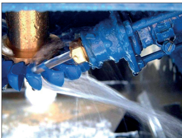
Slika 10: Princip rada Turgo turbine
