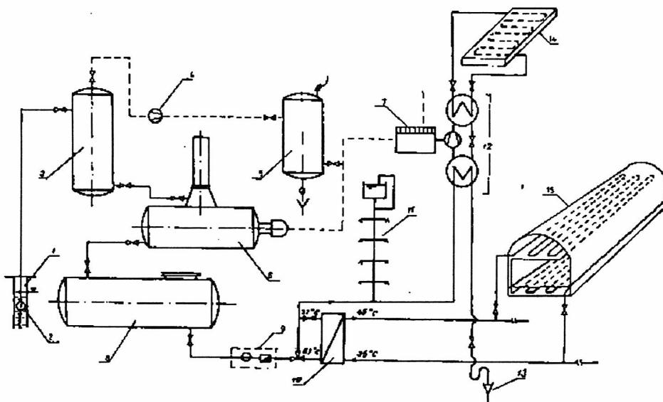
isparivaču, na kondenzatoru toplotne pumpe uspostavlja režim 68°/53°C koji omogućava da se toplotnom energijom snabdeva grejni sistem banjskog ili rekreativnog kompleksa 14. U toku negrejne sezone toplotna pumpa se može koristiti kao rashladna mašina, pri čemu se u sistem ugrađuje rashladna kula, a instalacija može poslužiti i kao klimatizaciona.
