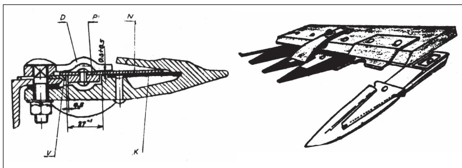
Slika 2. Prst nepokretnog dela oscilirajuće kose: a) D – držač noža (pritiskajuća šapa), V – vodica (tarna pločica), P – prut kose, K – protivrežuća pločica, N – pokretni nož kose, b) Izgled delova oscilirajuće kosačice [7]
