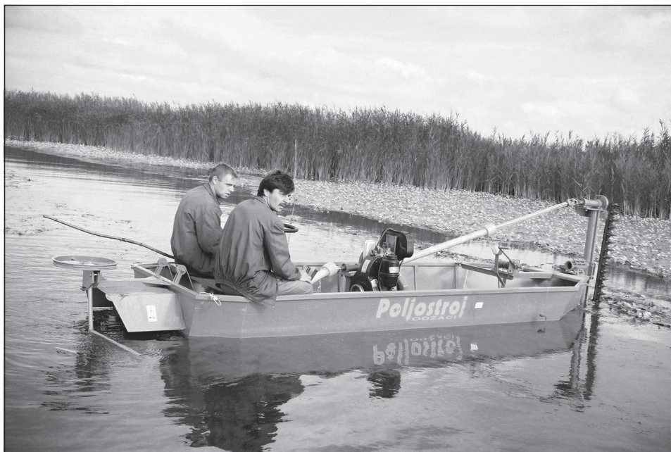
Slika 1. Kosačica sa čamcem – polazna konstrukcija za agregatiranje radnog vozila [13]
